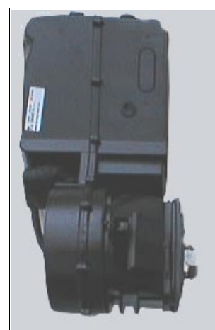
Il modulo HVAC
