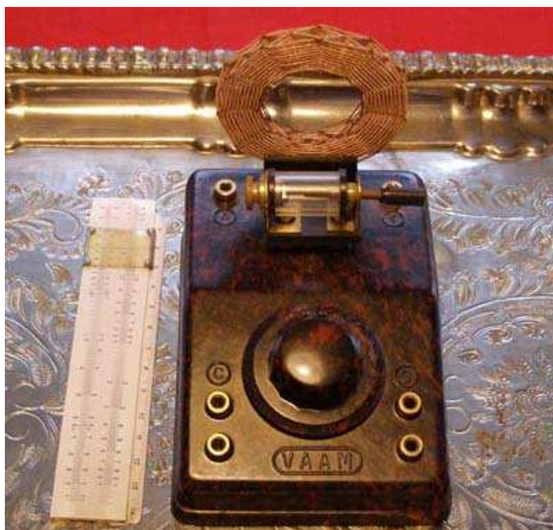
1) La radio a galena, si noti la bobina a nido d'ape e la capsula con il cristallo
