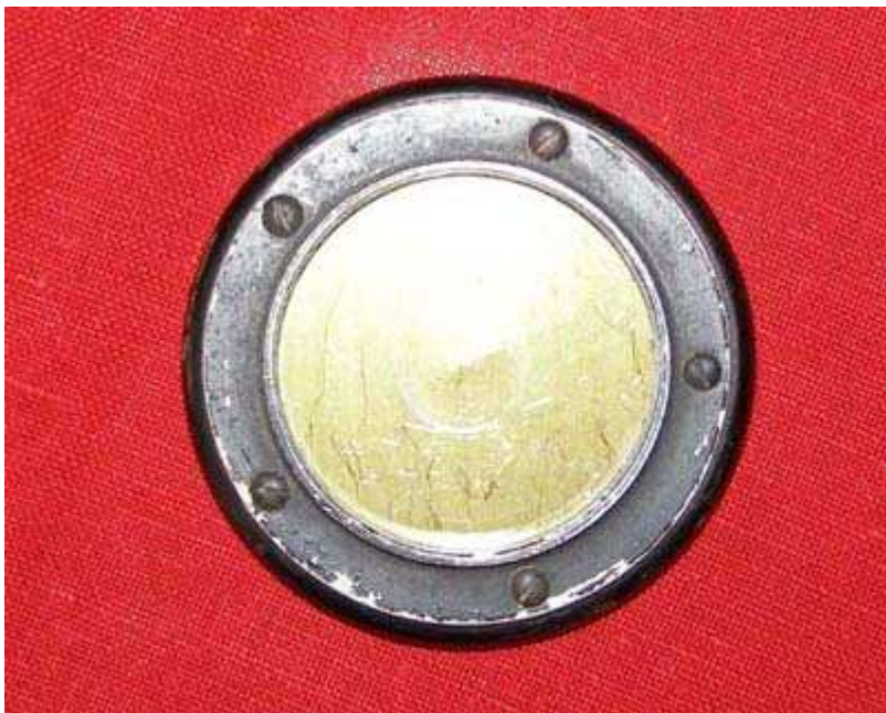
10) Interno di un "tambo" che chiude l'auricolare. Si noti la membrana che vibra al ritmo della corrente microfonica riproducendo
