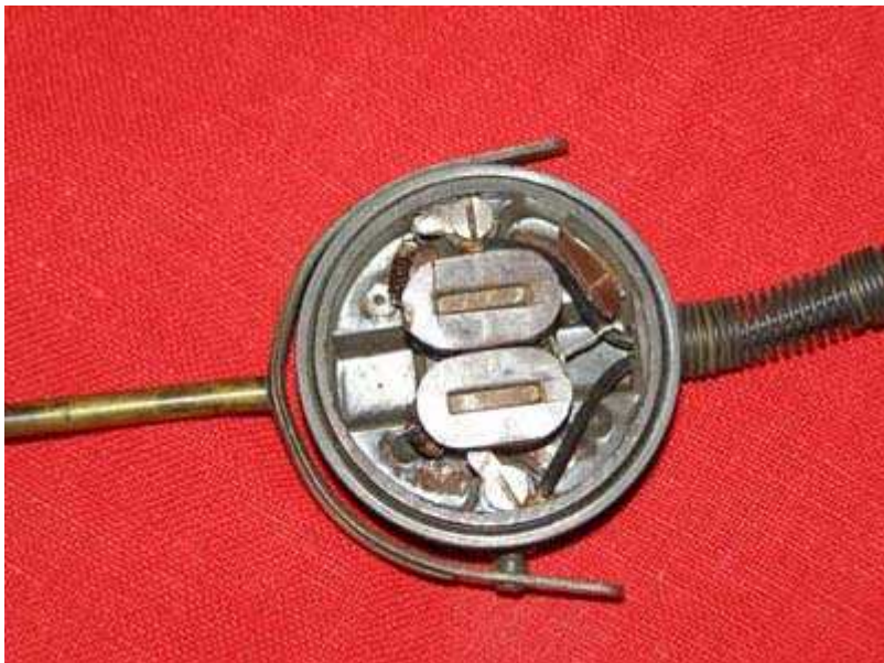
9) Interno di un auricolare. Si notino i due magneti con nucleo metallico centrale.
