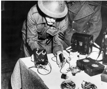
Gli ufficiali che espongono il S 88/5 trasmettitore di Kieboom & Pons. (Si noti la stretta chiave morse in mano del soldato).
