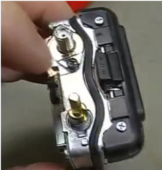
Connettore SMA femmina e relative viti superiori
