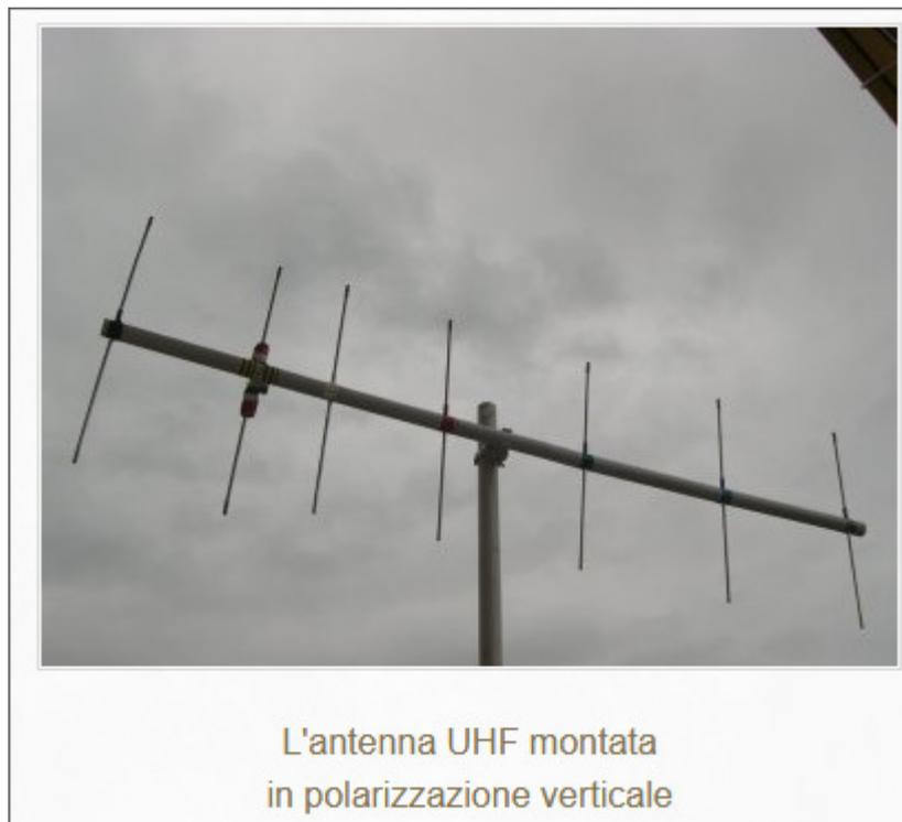
**antenna Yagi bi-banda per traffico satellitare 2 m / 70 cm**
